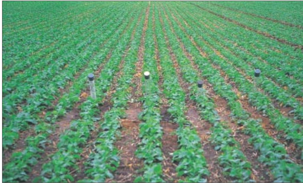
Mit diesen Rohren wurde die Entwicklung der Rapswurzeln beobachtet.
