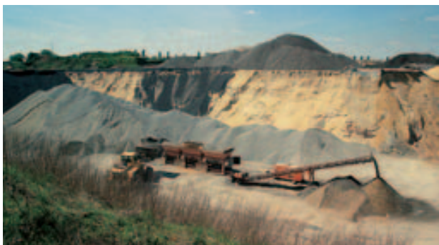
Abb. 10: Sandtagebau Klieken-Nord mit rezykliertem Asphalt-Straßenaufbruch. In dieser Gewinnungsstelle werden aus gesiebten Natursanden der Lagerstätte und Aufbruchmassen Mineralgemische für den Straßenbau hergestellt.
