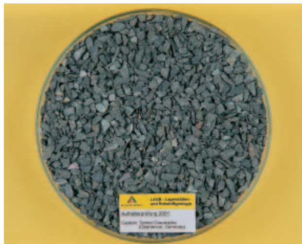
Abb. 6: Grauwacke (Gernrode), dunkelgrau, feinkörnig, selten grobkörnig, vereinzelt Quarz auf Klüften, sehr fest, in der Prüfkörnung überwiegend scherbis-splittrig brechend.
