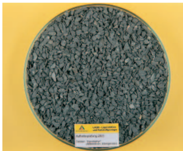
Abb.12: Keratophyr/Mikrosyenit (Elbingerode), dunkelgrau, dicht bis feinkristallin, vereinzelt Quarz auf Kluftbelägen, sehr fest, in der Prüfkörnung flachstänglich - splittrig brechend.
