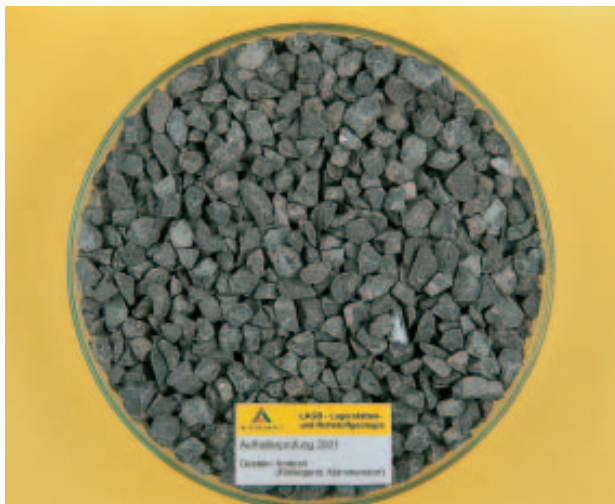
Abb. 10: Andesit (Mammendorf), dunkelviolettblau, dicht bis feinkristallin, fest, in der Prüfkörnung gedrunen brechend.
