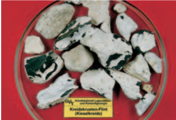
Abb. 5: Kreidekrusten um Feuerstein (Kreidekrustenflinte) in verschiedenen Stadien (Bereich östlich Halle). Diese ungeeignete Komponente bewirkt Betonschäden durch Treibreaktionen.
