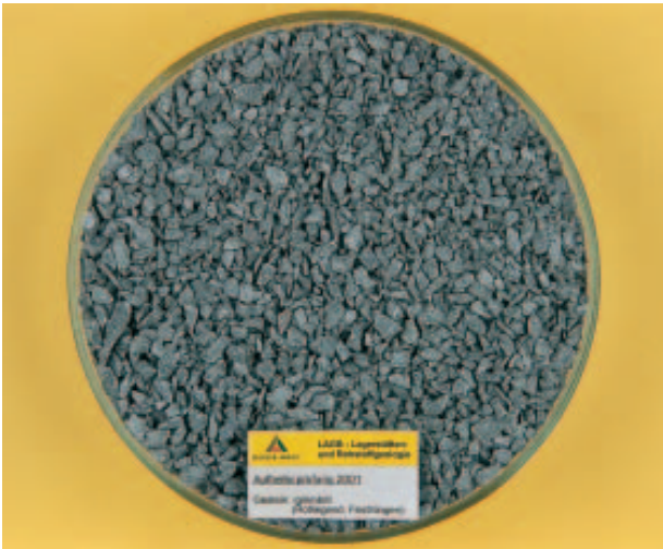
Abb. 8: Ignimbrit (Flechtingen), hellgrüngrau, dicht bis feinkristallin, sehr fest, in der Prüfkörnung gedrunken bis länglich - splittig brechend.
