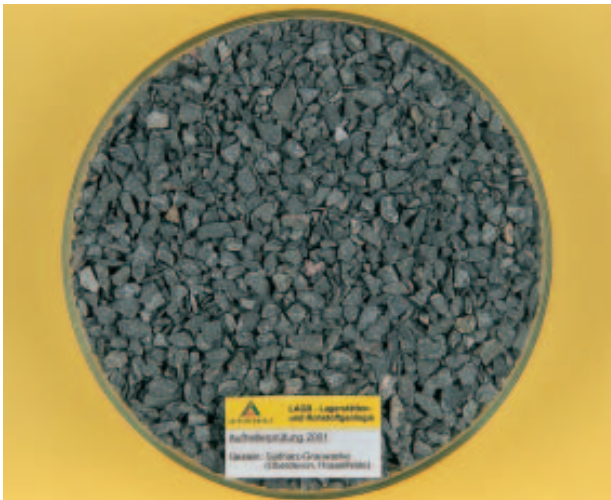
Abb. 7: Grauwacke (Südharz), dunkelgrau, überwiegend feinkörnig, Quarz auf Klüften, sehr fest, in der Prüfkörnung scharf-splittrig bis gedrunken brechend.
