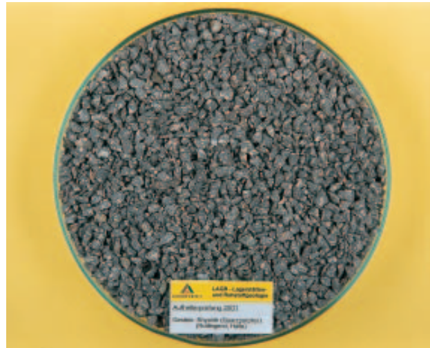
Abb. 9: Rhyolith, (Oberer Hallescher Porphyry, Brachstedt), violettbraun, zahlreiche kleine, helle Feldspateinsprenglinge in dichter bis feinkristalliner Grundmasse, fest, in der Prüfkörnung gedrunken Bruch.
