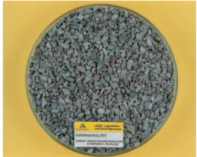
Abb. 3: Quarzit (Ilsenburg), hellviolettgrau, überwiegend feinkörnig bis dicht, sehr fest, gedrunen bis schwach splittrig brechend.
