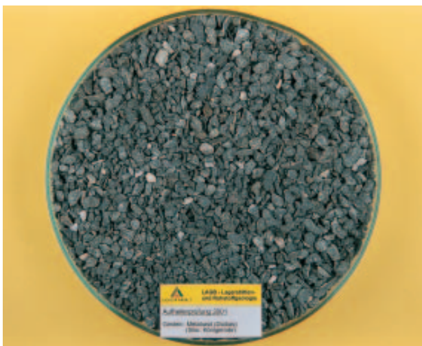
Abb. 11: Diabas/Metabazit (Königerode), dunkelgrau, schwach grünlich, feinkristallin, Quarze auf Kluftbelägen, fest, in der Prüfkörnung überwiegend gedrunen brechend.
